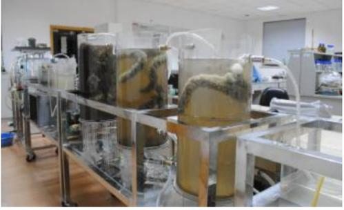
图为造纸废水处理系统装置
